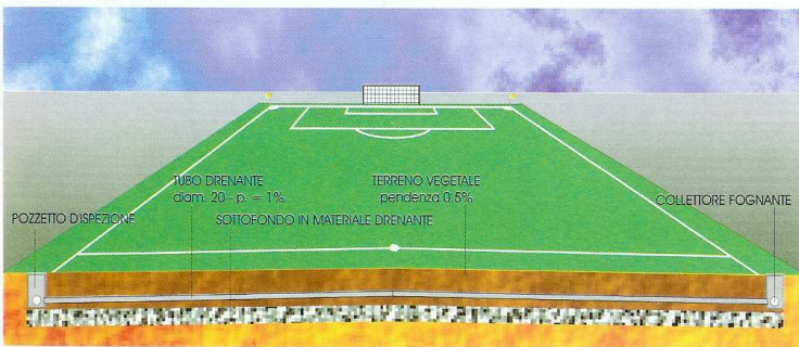
DRENAGGIO SUPERFICIALE DI CAMPI DI CALCIO
